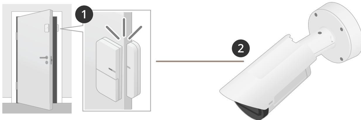
この例では、カメラはドアの近くに配置されていて、ドアセンサーはケーブルでカメラのI/Oポートに接続されています。
