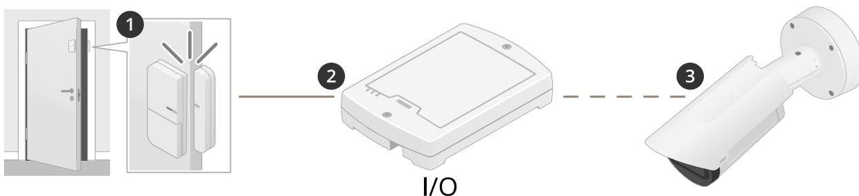
この例では、カメラはドアの近くに配置されていません。ドアセンサーはI/Oリレーにケーブルで接続されていて、そのリレーはネットワークを介してカメラに接続されています。
