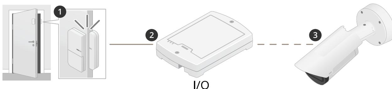
Nesse caso, a câmera não está localizada próxima à porta. O sensor de porta é conectado por cabo a um relé de E/S, o qual é conectado à câmera através da rede.
