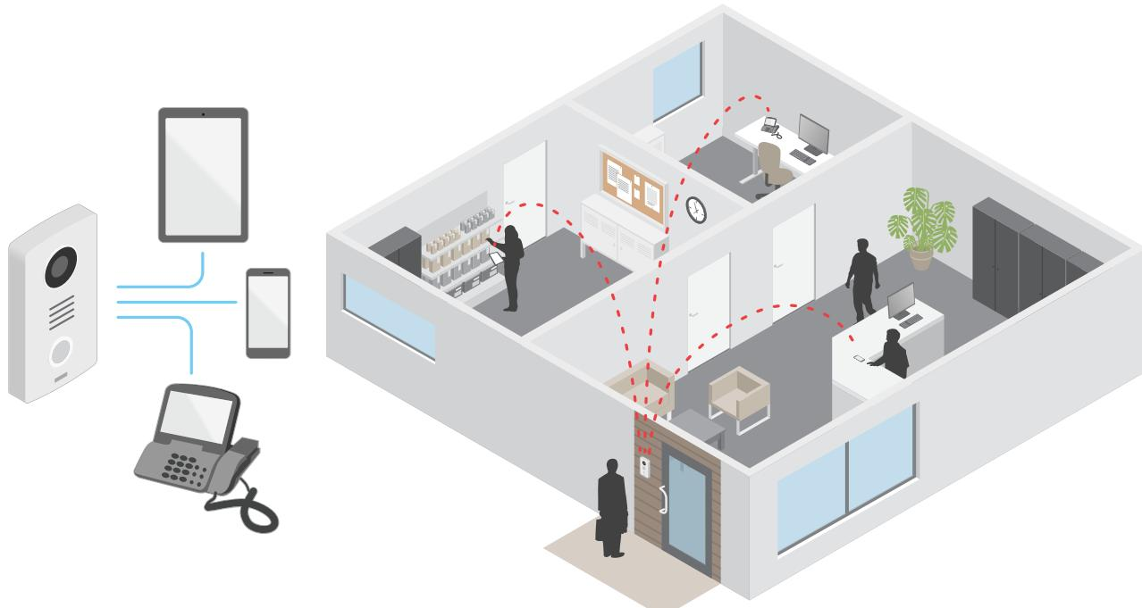
Wenn Sie die Anruftaste einer Axis IP-Türsprechanlage drücken, wird ein Anruf für einen oder mehrere vordefinierte Empfänger initiiert. Wenn ein Empfänger antwortet, wird ein Anruf eingerichtet. Die Sprach- und Videoübertragung erfolgt über VoIP-Technologien.
