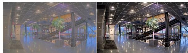
**輝度**:スライダーを使用して光の強度を調整します。これにより、対象物が見やすくなります。輝度は画像キャプチャーの後で適用され、画像内の情報には影響しません。暗い場所でより詳細に表示するには、ゲインや露光時間を増やすのが一般的です。
