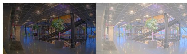
**Sharpness (シャープネス)**:スライダーを使ってエッジのコントラストを調整することで、画像内の物体をよりシャープに見せることができます。シャープネスを上げると、ビットレートが上がり、必要なストレージ容量も増加する可能性があります。
