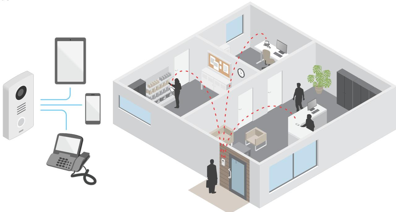
Axisインターラムで呼び出しボタンを押すと、1つ以上の既定の送信先への呼び出しが開始されます。送信先が応答すると、呼び出しが確立されます。VoIPテクノロジーで音声と映像が転送されます。
