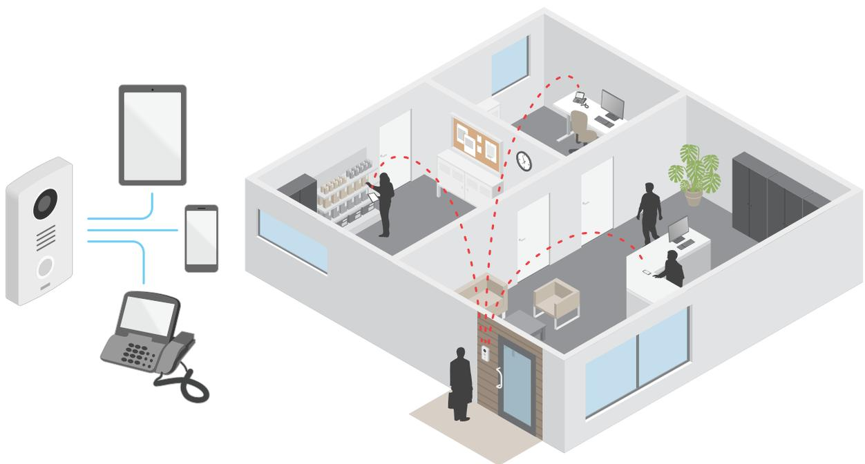
Quando si preme il pulsante di chiamata su un intercom Axis, viene avviata una chiamata a uno o più destinatari predefiniti. Quando un destinatario risponde, viene stabilita una chiamata. La voce e il video vengono trasferiti tramite le tecnologie VoIP.
