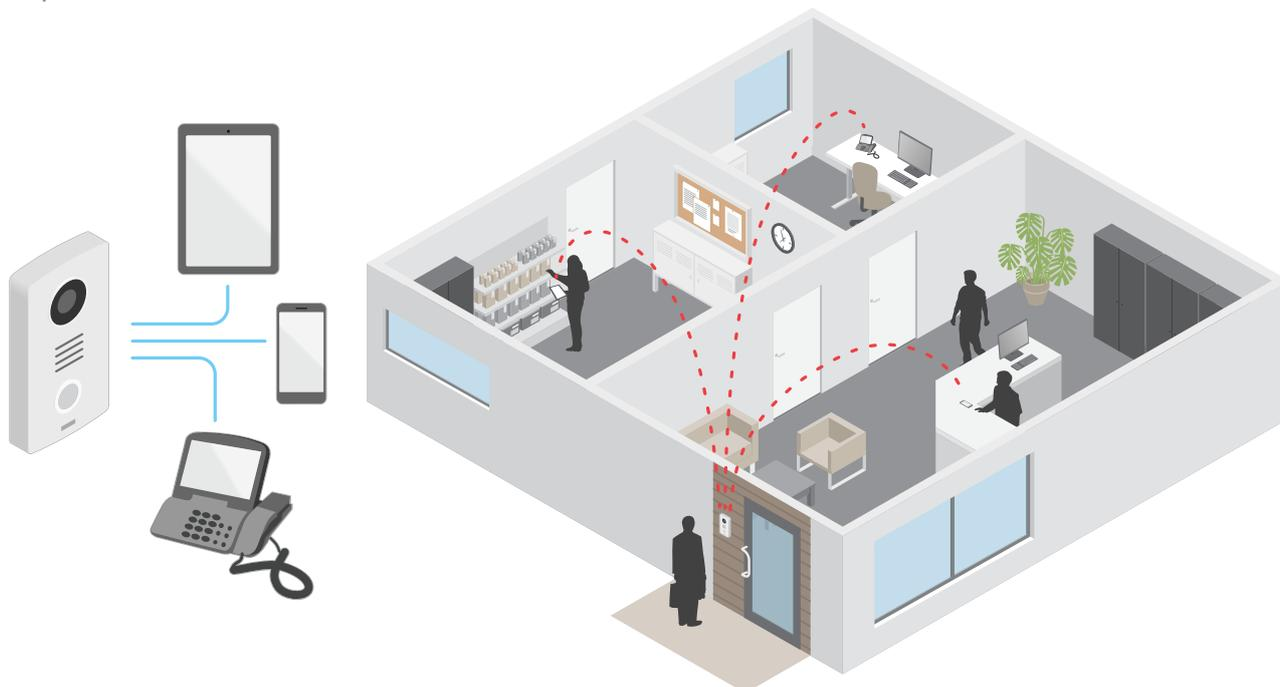
Wenn Sie die Anruftaste einer Axis IP-Türsprechanlage drücken, wird ein Anruf für einen oder mehrere vordefinierte Empfänger initiiert. Wenn ein Empfänger antwortet, wird ein Anruf eingerichtet. Die Sprach- und Videoübertragung erfolgt über VoIP-Technologien.
