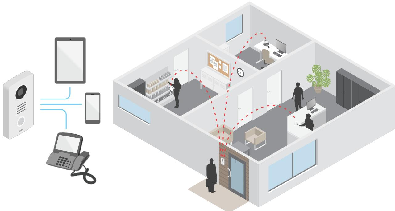
Quando si preme il pulsante di chiamata su un intercom Axis, viene avviata una chiamata a uno o più destinatari predefiniti. Quando un destinatario risponde, viene stabilita una chiamata. La voce e il video vengono trasferiti tramite le tecnologie VoIP.
