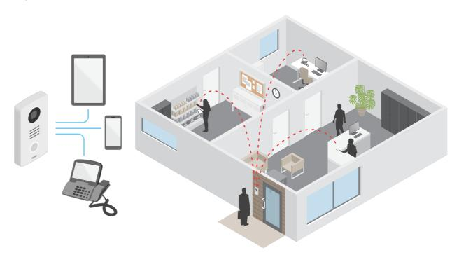
Wenn Sie die Anruftaste einer Axis Gegensprechanlage drücken, wird ein Anruf für einen oder mehrere vordefinierte Empfänger initiiert. Wenn ein Empfänger antwortet, wird ein Anruf eingerichtet. Die Sprach- und Videoübertragung erfolgt über VolP-Technologien.
