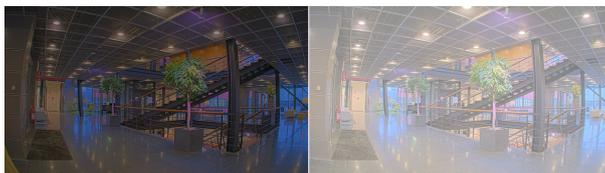
**Sharpness (Nitidez)**: Utilice el control deslizante para que los objetos en la imagen aparezcan con mayor nitidez mediante el ajuste del contraste de los bordes. Si aumenta la nitidez, podría aumentar la velocidad de bits y la cantidad de espacio de almacenamiento necesaria también.
