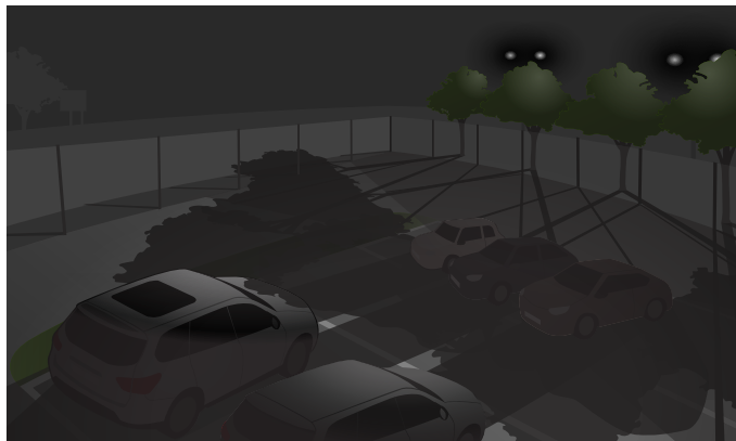
La même scène où les projecteurs derrière les arbres provoquent des ombres longues.
