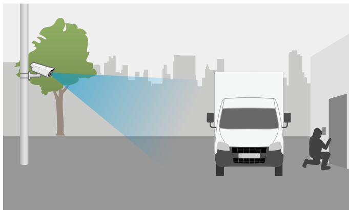
意図的に駐車されたトラックによってカメラの視界が遮られている
