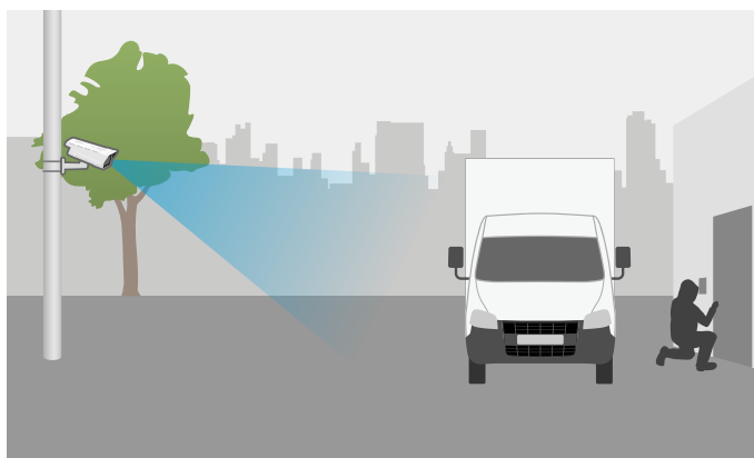
A visão da câmera é bloqueada por um caminhão estacionado intencionalmente
