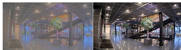
**Helligkeit:** Stellen Sie mithilfe des Schiebereglers die Lichtstärke ein. Dadurch lassen sich Objekte leichter erkennen. Helligkeit wird nach der Bildaufnahme angewendet und hat keine Auswirkungen auf die Bilddaten. Um mehr Details aus dunklen Bereichen zu erhalten, ist es normalerweise besser, die Verstärkung oder die Belichtungszeit zu erhöhen.
