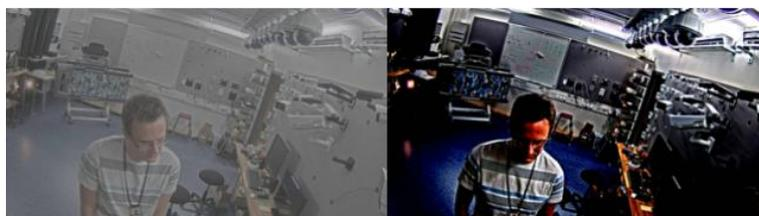
**Brightness (輝度):** スライダーを使用して光の強度を調整します。これにより、対象物が見やすくなります。輝度は画像キャプチャーの後で適用され、画像内の情報には影響しません。暗い場所でより詳細に表示するには、ゲインや露光時間を増やすのが一般的です。
