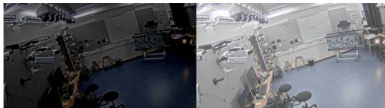
**Schärfe:** Stellen mithilfe des Schiebereglers den Randkontrast ein, um Objekte in einem Bild schärfer darzustellen. Wenn Sie die Schärfe erhöhen, kann dies zu einer höheren Bitrate und einem höheren Bedarf an Speicherplatz führen.
