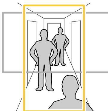
1. A seconda del dispositivo, ruotare la telecamera o l'obiettivo a 3 assi nella telecamera di 90° o 270°.
