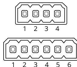
1. Conecte a outra extremidade do fio terra ao pino 1 (GND/-).
