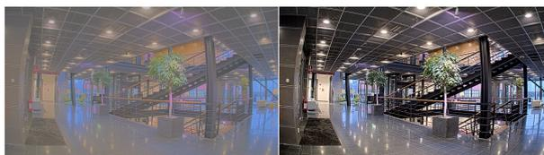
**Brightness (Luminosité)** : Utilisez le curseur pour ajuster l'intensité lumineuse. Cela peut rendre les objets plus visibles. La luminosité est appliquée après la capture de l'image et n'affecte pas les informations contenues dans l'image. Pour obtenir davantage de détails d'une zone sombre, il est parfois préférable d'accroître le gain ou le temps d'exposition.
