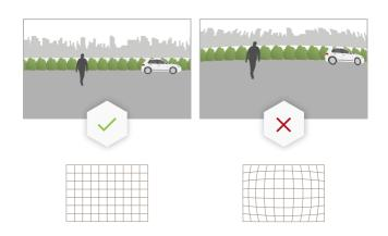
右边的图像是桶形畸变的一个例子。筒形畸变是一种镜头现象,其中直线显示逐渐变得距离帧边缘更近。 可能延迟或遗漏侦测的条件
