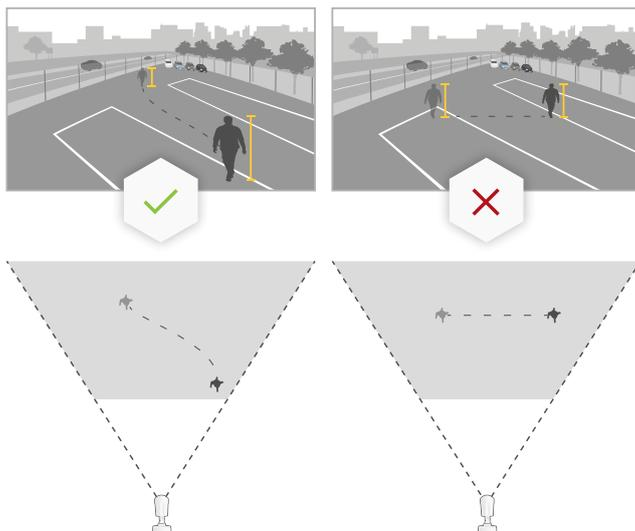
3. Platzieren Sie die Leisten neben den Objekten und passen Sie die Länge der jeweiligen Leiste an die Höhe des Objekts an.
