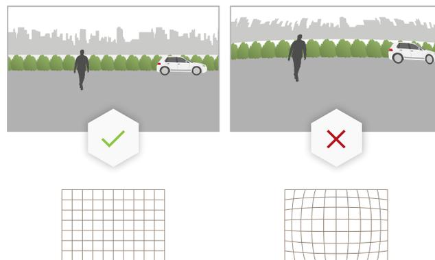
*L'image à droite est un exemple de distorsion en barillet. La distorsion en barillet est un effet d'objectif dans lequel les lignes droites apparaissent plus courbées près des bords de l'image.*
