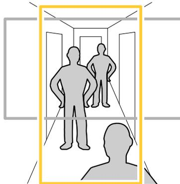
1. A seconda del dispositivo, ruotare la telecamera o l'obiettivo a 3 assi nella telecamera di 90° o 270°.
