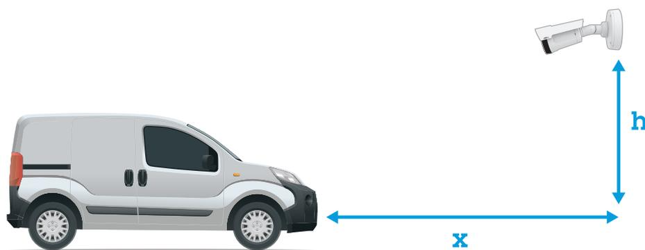
Distance de capture du contrôle d'accès : 2-7 m (6,6-23 pi). Cet exemple est basé sur l'AXIS P3265-LVE-3 License Plate Verifier kit.
