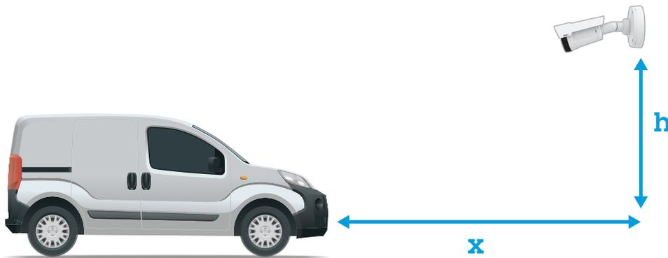
Access control (門禁監控) 擷取距離：2—7 公尺 (6.6—23 英尺)。此範例是依據 AXIS P3265—LVE-3 License Plate Verifier kit。
