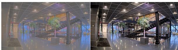
**Brightness (Brillo)**: Utilice el control deslizante para ajustar la intensidad de la luz. Esto puede hacer que los objetos sean más fáciles de ver. El brillo se aplica después de capturar la imagen y no afecta a la información de la imagen. Para obtener más detalles de una zona oscura, normalmente es mejor aumentar la ganancia o el tiempo de exposición.
