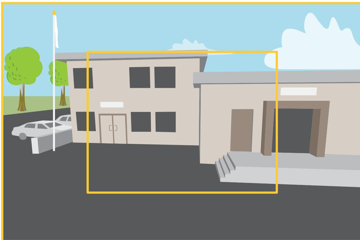
*La imagen muestra cómo pueden cambiar el campo de visión y la relación de aspecto en dos modos de captura distintos. El modo de captura a elegir depende de los requisitos de velocidad de fotogramas y resolución de la configuración de vigilancia específica. Para conocer las especificaciones de los modos de captura disponibles, consulte la hoja de datos del producto en [axis.com](http://axis.com).*
