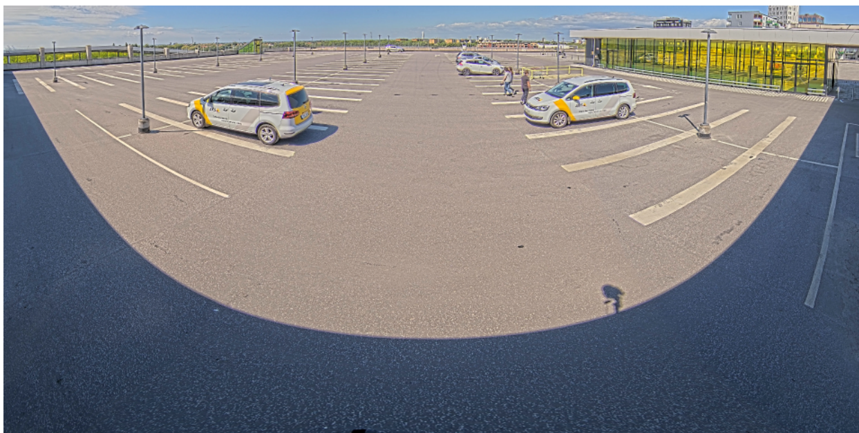
Capture panoramique à 180° prise avec une caméra multicapteur avec redressement de l'horizon. L'horizon est droit et les objets verticaux sont verticaux.
