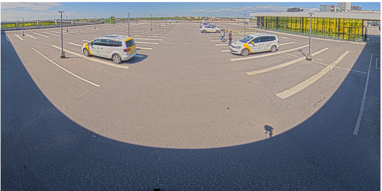
Vue panoramique à 180 degrés prise avec une caméra multicateur avec redressement de l'horizon. L'horizon est droit et les objets verticaux sont verticaux.
