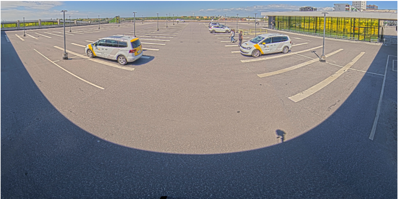
수평선 직선화를 적용하여 멀티 센서 카메라로 촬영한 180도 파노라마 보기 스냅샷. 수평선은 직선이고 수직 객체는 수직입니다.
