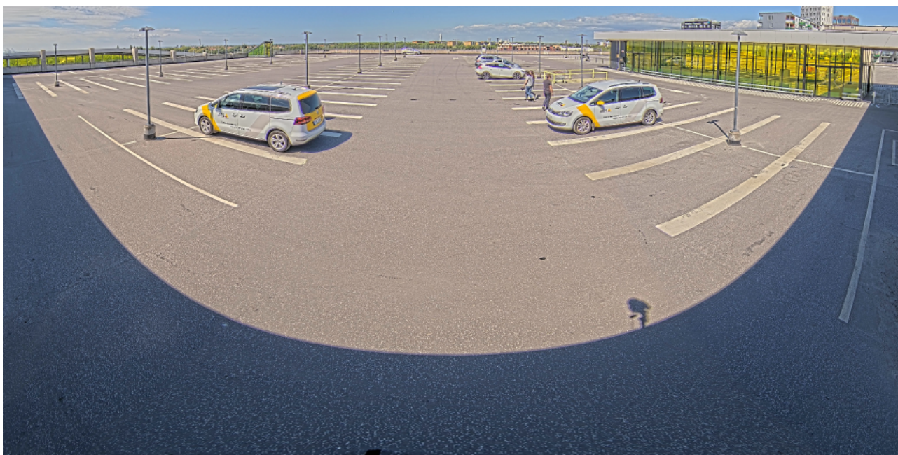
Zdjęcie 180-stopniowego widoku panoramicznego wykonane przy użyciu kamery wieloprzetwornikowej z funkcją prostowania linii horyzontu. Horyzont jest prosty, a pionowe obiekty są wyświetlane jako pionowe.
