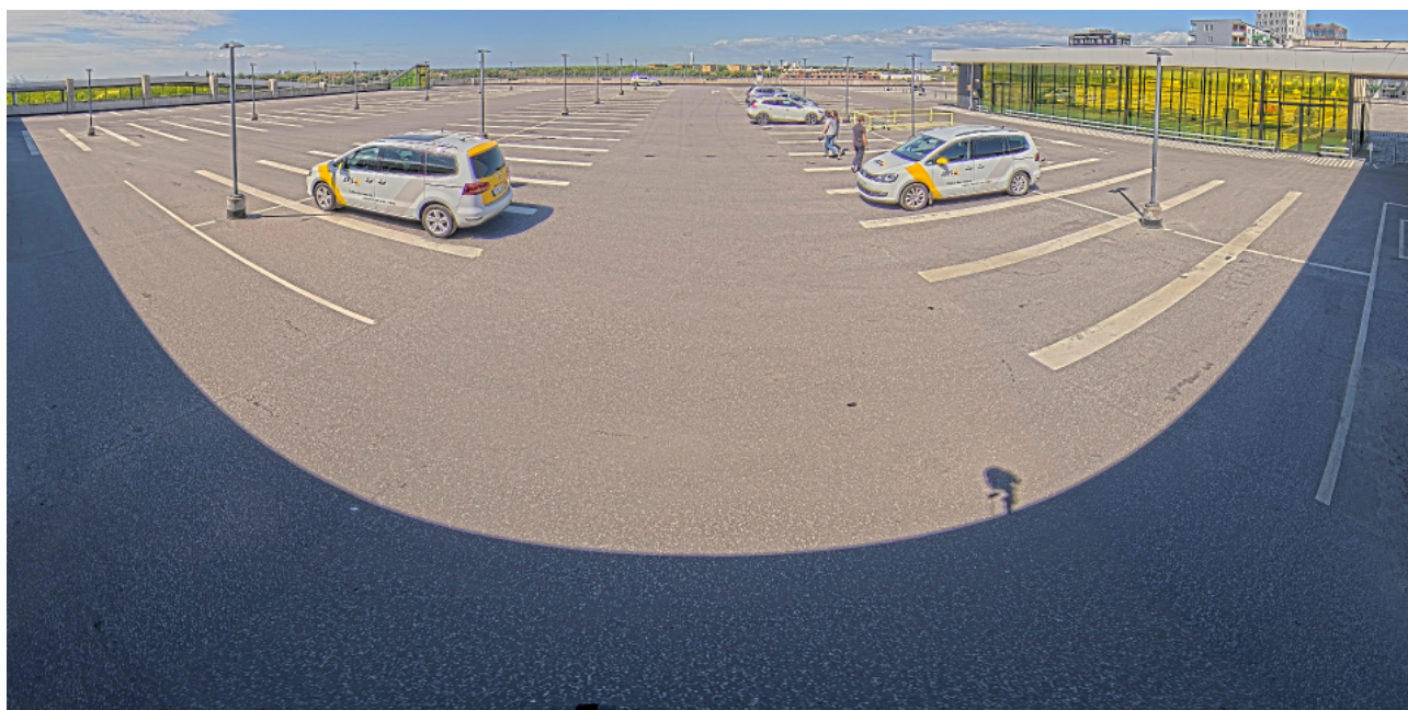
Instantâneo com visão panorâmica de 180 graus capturado com uma câmera multissensor com nivelamento de horizonte. O horizonte é reto e os objetos verticais são verticais.
