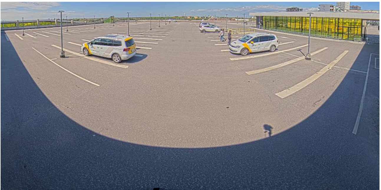
在执行地平线矫正的情况下，使用多传感器摄像机抓拍的180度全景快照。地平线为直线，垂直物体保持垂直。要了解更多信息，请参见 axis.com/learning/white-papers 的白皮书“地平线伸直”。
