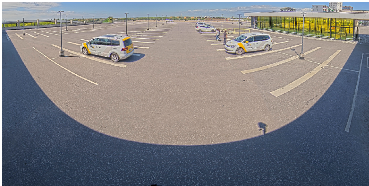
在执行地平线矫正的情况下，使用多传感器摄像机抓拍的180度全景快照。地平线为直线，垂直物体保持垂直。
