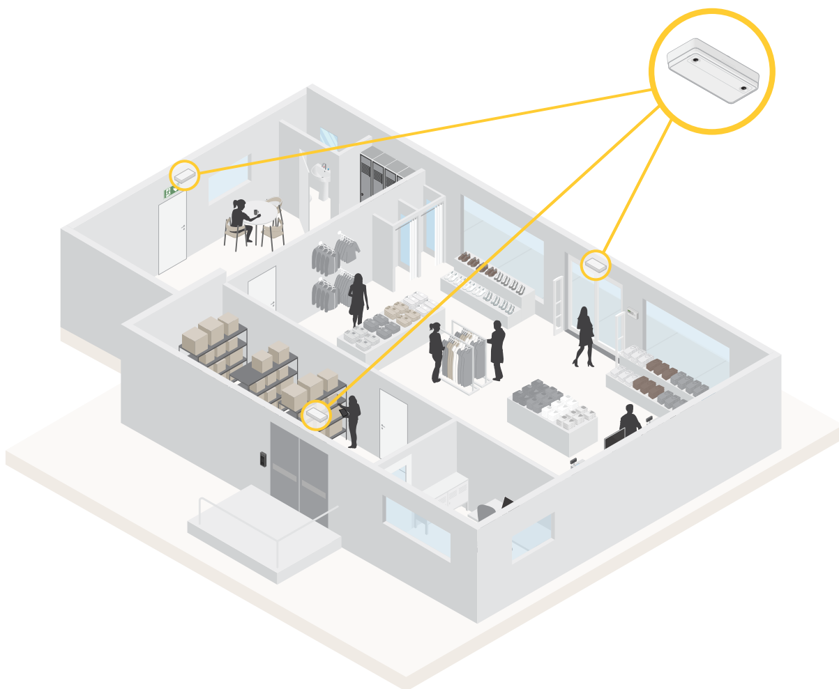
Przykład sklepu z urządzeniami AXIS P8815-2 3D People Counter przy każdym wejściu.
