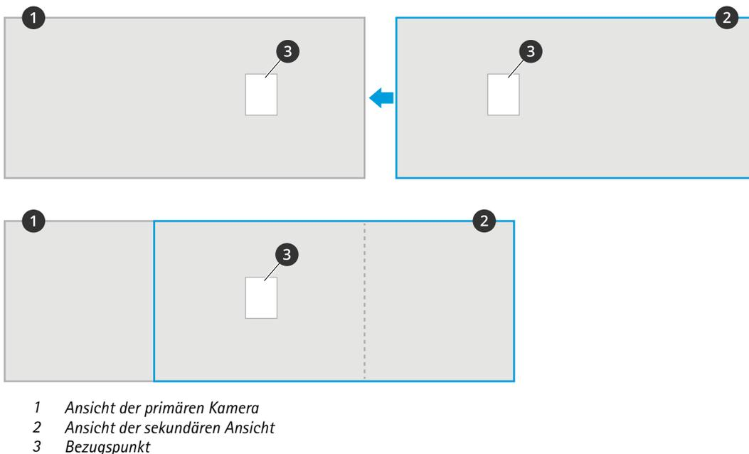
9. Nach Abschluss der Kalibrierung gehen Sie zur **Live-Ansicht** der primären Kamera, um die Live-Ansichten der sekundären Kameras zu sehen.
