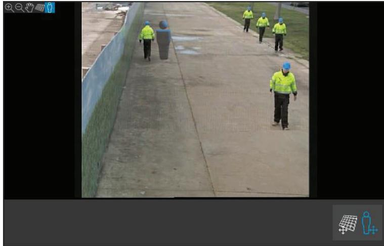
ビューペインでのアバターのサイズは、現在のキャリブレーションでその位置にいる平均的なサイズの人物に対応しています。アバターをその周辺で移動させると、シーン内の他の物体や人物と比較してそのサイズが妥当であることを確認できます。アバターのサイズが画像内のある位置では正しくても、別の場所ではサイズが誤っている場合があるため、異なる位置でアバターを確認する必要があります。
