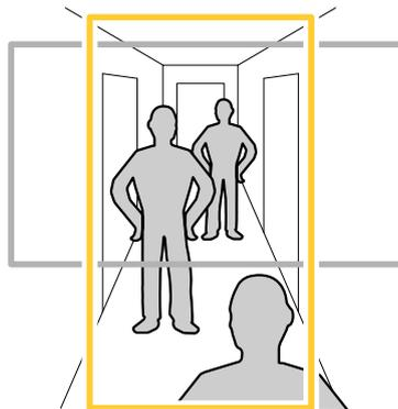
1. Drehen Sie je nach Gerät die Kamera oder das 3-Axis-Objektiv in der Kamera um 90° oder 270°.
