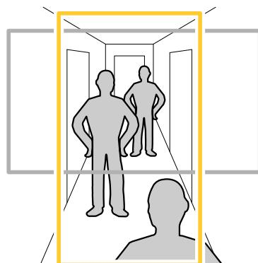
1. デバイスによって、カメラまたはカメラの3軸レンズの向きを90° または270° 回転します。
