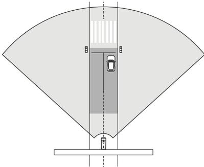
Damit das Radar der AXIS Q1656-DLE hohe Geschwindigkeiten präzise messen kann, positionieren Sie die Radar-Video-Überwachungskamera in einem seitlichen Abstand von 10 m zu den Fahrzeugen. Weitere Informationen zum Erfassungsbereich und zur Genauigkeit von Geschwindigkeiten finden Sie unter *Erfassungsbereich der Straßenüberwachung auf Seite 10*.
