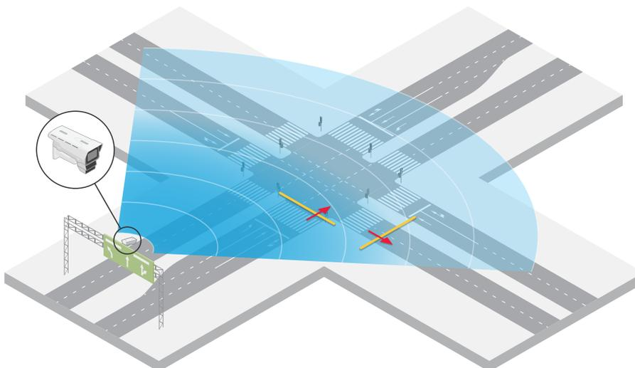
Für die Überwachung des Verkehrsflusses in alle Richtungen wird für jede Richtung ein Radarszenario erstellt. Informationen zum Einrichten eines Radarszenarios finden Sie unter *Szenarien hinzufügen auf Seite 31*.
