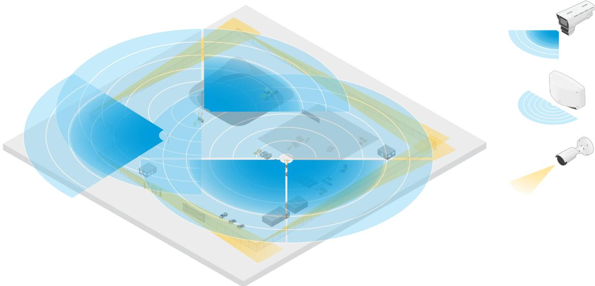
*Ein Beispiel für eine Baustelle, auf der zwei eigenständige Radarsysteme die freien Bereiche des Standorts abdecken, während vier Radarvideokameras die komplexeren offenen Bereiche abdecken. Zusätzlich decken vier Wärmebildkameras die schmalen Korridore entlang des Zauns ab.*
