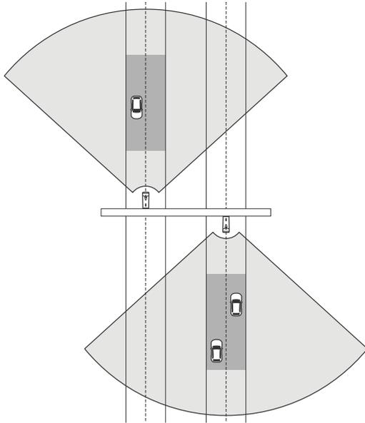
Dieselbe Installation eignet sich zur Überwachung von Fahrzeugen, die von der Radar-Video-Fusion-Kamera wegfahren, anstatt darauf zuzufahren.
