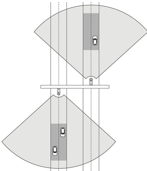
Auch lässt sich die Radar-Video-Fusion-Kamera an einem Gerüst mit Blick auf eine Fußgängerüberquerung mit Ampelsignal platzieren, um beispielsweise die Geschwindigkeiten fahrender Fahrzeuge zu protokollieren oder Geschwindigkeitsüberschreitungen zu erfassen.
