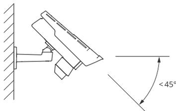
Puede agregar una superposición en la visualización en directo del radar que muestre el ángulo de inclinación del producto. Para obtener instrucciones, consulte .
