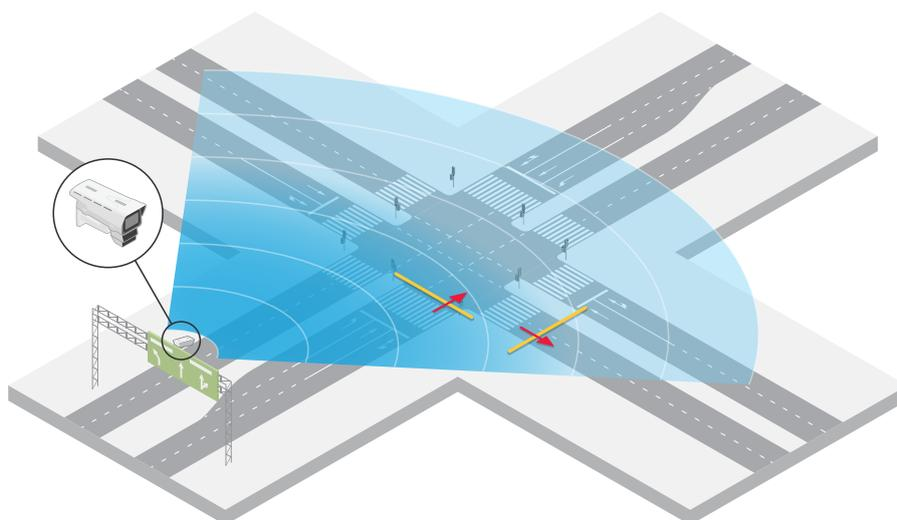
Para supervisar el flujo de tráfico en todas las direcciones, crean un escenario de radar para cada dirección. Para obtener información sobre cómo configurar un escenario de radar, consulte .
