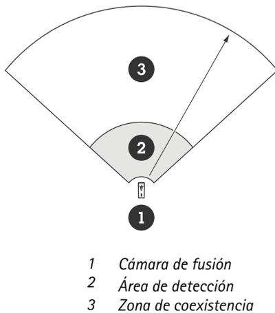
AXIS Q1656-DLE funciona en la banda de frecuencia de 60 GHz. Puede instalar hasta ocho radares o cámaras de fusión de radar y vídeo de Axis que funcionen en una banda de frecuencia de 60 GHz cerca entre sí o uno frente a otro, sin causar problemas. El algoritmo integrado de coexistencia puede encontrar una ranura de tiempo y un canal de frecuencia adecuados que reducirán las interferencias.
