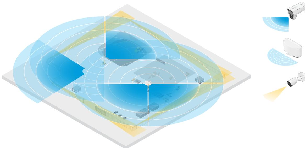
*Un ejemplo de una obra con dos radares independientes que cubren las áreas abiertas de la instalación y cuatro cámaras de fusión de radar y vídeo que cubren las áreas abiertas más complejas. Además, cuatro cámaras térmicas cubren los pasillos estrechos a lo largo de la valla.*
