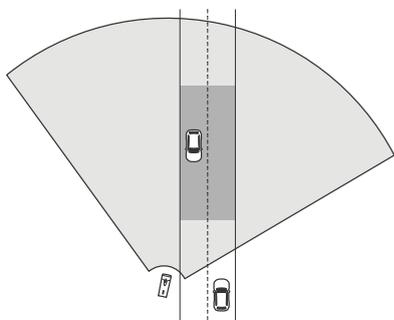
Para que el radar de la AXIS Q1656-DLE pueda medir altas velocidades con precisión, coloque la cámara de fusión de radar y vídeo a una distancia lateral de 10 m de los vehículos. Para obtener más información sobre el rango de detección y la precisión de la velocidad, consulte .
