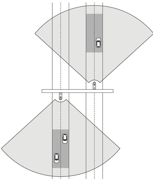
También puede colocar la cámara de fusión de radar y vídeo en una grúa que dé un paso de peatones con semáforos, por ejemplo, para registrar la velocidad de los vehículos que salen o detectar infracciones de velocidad.
