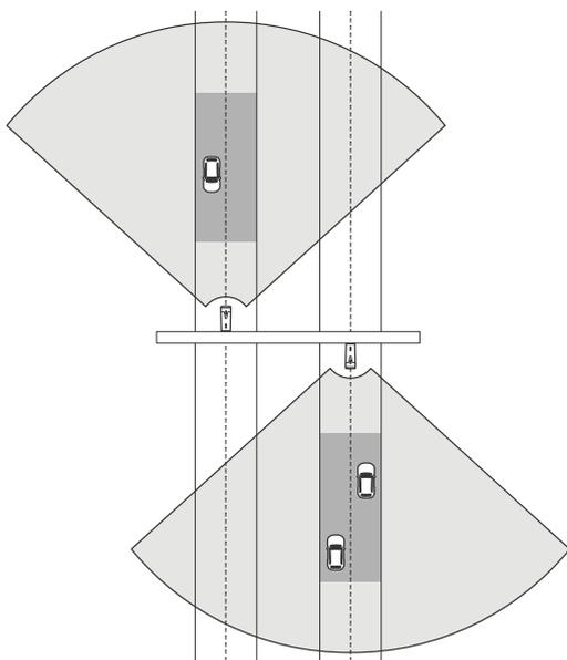
Lo stesso tipo di installazione è possibile se si desidera monitorare i veicoli che, invece di avvicinarsi, si allontanano dalla telecamera con fusione radar-video.
