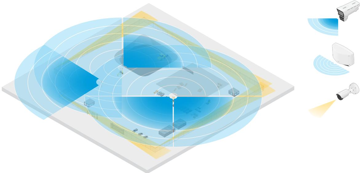
*Esempio di cantiere in cui due radar indipendenti coprono le aree aperte del sito, mentre quattro telecamere con fusione radar-video coprono le aree aperte più complesse. Inoltre, quattro telecamere termiche coprono gli stretti corridoi lungo la recinzione.*
