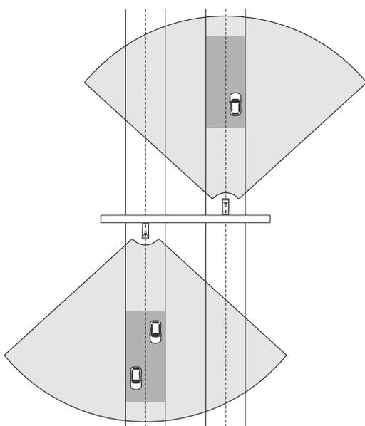
È inoltre possibile posizionare la telecamera con fusione radar-video su un cavalletto sopra a un passaggio pedonale con semaforo, ad esempio per registrare la velocità dei veicoli in circolazione o rilevare violazioni dei limiti di velocità.
