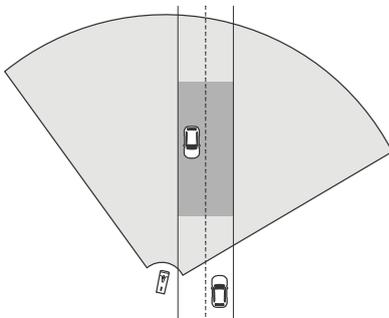
Per fare in modo che il radar in AXIS Q1656-DLE misuri le alte velocità in modo preciso, posizionare la telecamera con fusione radar-video a una distanza laterale di 10 m dai veicoli. Per ulteriori informazioni sull'accuratezza dell'intervallo di rilevamento e della velocità, consultare *Intervallo di rilevamento su strada alla pagina 9*.
