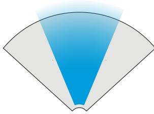
Afin d'optimiser les chances de classification précise d'un objet à la fois par le radar et l'analyse vidéo, réglez le zoom dans la mesure du possible de sorte que les objets de la zone d'intérêt soient suffisamment grands pour être détectés par l'analyse vidéo.
