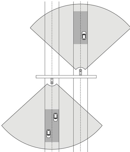
Vous pouvez également placer la caméra de fusion radar-vidéo sur une allée donnant sur un passage pour piétons avec des feux de signalisation, par exemple pour enregistrer les vitesses des véhicules ou détecter des infractions de vitesse.
