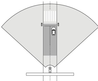
Pour que le radar de l'AXIS Q1656-DLE mesure les vitesses élevées avec précision, positionnez la caméra de fusion radar-vidéo à une distance latérale de 10 m (32 pi) des véhicules. Pour plus d'informations sur la portée de détection et la précision de la vitesse, consultez .
