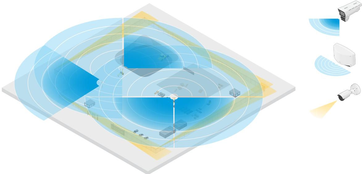
*Um exemplo é um canteiro de obras com dois radares autônomos que cobrem as áreas abertas do local e quatro câmeras de fusão radar-vídeo que cobrem áreas abertas mais complexas. Além disso, quatro câmeras térmicas cobrem corredores estreitos ao longo da cerca.*
