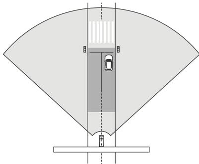
Para possibilitar que o radar no AXIS Q1656-DLE meça velocidades elevadas com precisão, posicione a câmera de fusão de radar-vídeo a uma distância lateral de 10 m (32 ft) em relação aos veículos. Para obter mais informações sobre o alcance da detecção e a precisão da velocidade, consulte .
