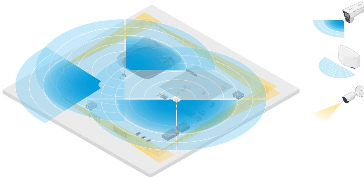
*Um exemplo é um canteiro de obras com dois radares autônomos que cobrem as áreas abertas do local e quatro câmeras de fusão radar-vídeo que cobrem áreas abertas mais complexas. Além disso, quatro câmeras térmicas cobrem corredores estreitos ao longo da cerca.*
