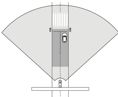
Para possibilitar que o radar no AXIS Q1656-DLE meça velocidades elevadas com precisão, posicione a câmera de fusão de radar-vídeo a uma distância lateral de 10 m (32 pés) em relação aos veículos. Para obter mais informações sobre o alcance da detecção e a precisão da velocidade, consulte .
