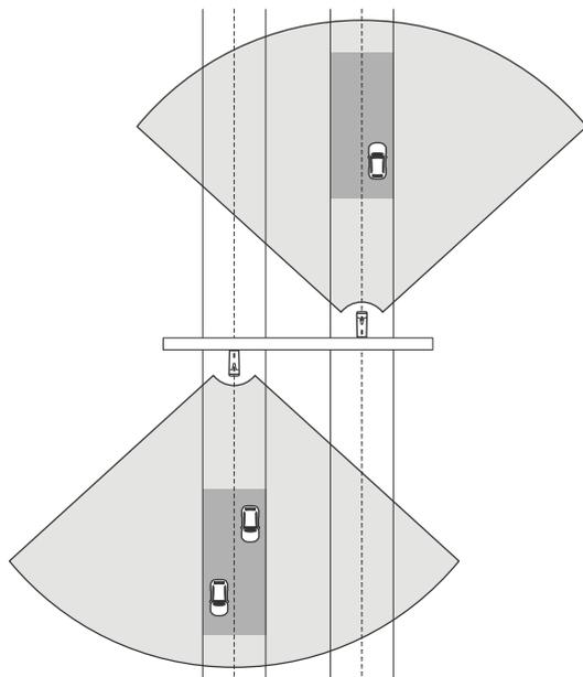
Você também pode colocar a câmera de fusão de radar-vídeo em um pórtico com vista para faixas de pedestres com semáforos, por exemplo, para registrar as velocidades dos veículos que saem ou detectar manipulações de velocidade.
