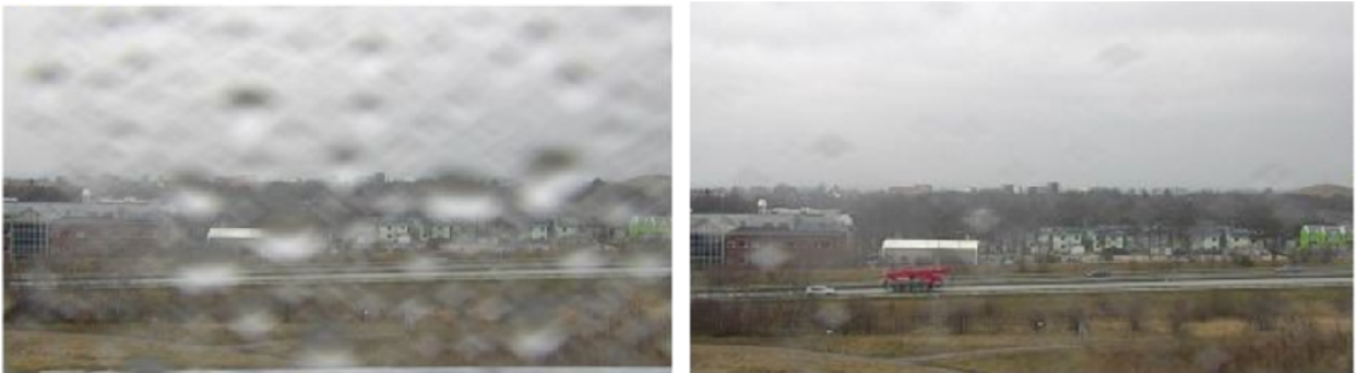
Instantánea de la visualización en directo de una cámara antes y después de que se haya activado speed dry.
