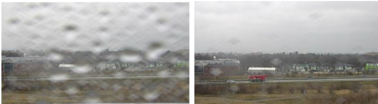
O instantâneo da visualização ao vivo de uma câmera antes e após a secagem rápida ser ativada.
