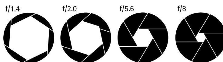
Exemples d'ouvertures pour différentes valeurs f .
