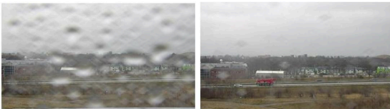
Capture d'image de la vidéo en direct d'une caméra avant et après l'activation de la fonction de séchage rapide.
