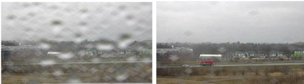
Istantanea dalla visualizzazione in diretta della telecamera prima e dopo l'attivazione della funzione Speed Dry.
