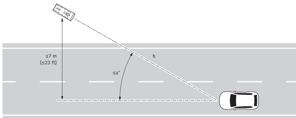
Für seitlich montierte Kameras beträgt der empfohlene maximale seitliche Abstand zur am weitesten entfernten Fahrspur 7 m (siehe Abbildung). Die Abbildung zeigt außerdem den Schwenkwinkel (a) und die Erfassungsdistanz (b).
