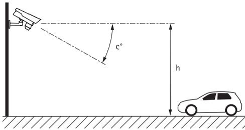
Zusätzlich sind der Neigungswinkel (c) des Geräts nach unten und die Montagehöhe (h) vom Boden bis zum Gerät dargestellt.
