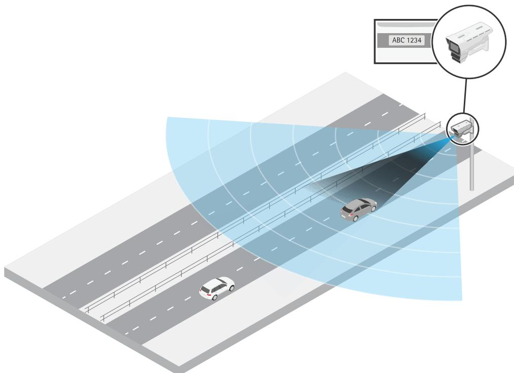
*Die AXIS Q1686-DLE wird an einem Mast neben der Autobahn montiert. Von dort aus misst sie die Geschwindigkeit und erfasst die Fahrzeugkennzeichen von sich nähernden Fahrzeugen.*
