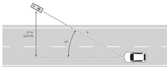
Informationen zu Schwenkwinkel (a) und Erfassungsdistanz (b) sowie Empfehlungen zur Montage des Geräts bei Verwendung von AXIS License Plate Verifier finden Sie unter .
