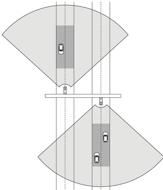
Dieselbe Installation eignet sich zur Erfassung der Fahrzeugkennzeichen und zur Messung der Geschwindigkeit von Fahrzeugen, die sich von der Radar-Video-Fusion-Kamera entfernen, anstatt sich ihr zu nähern.
