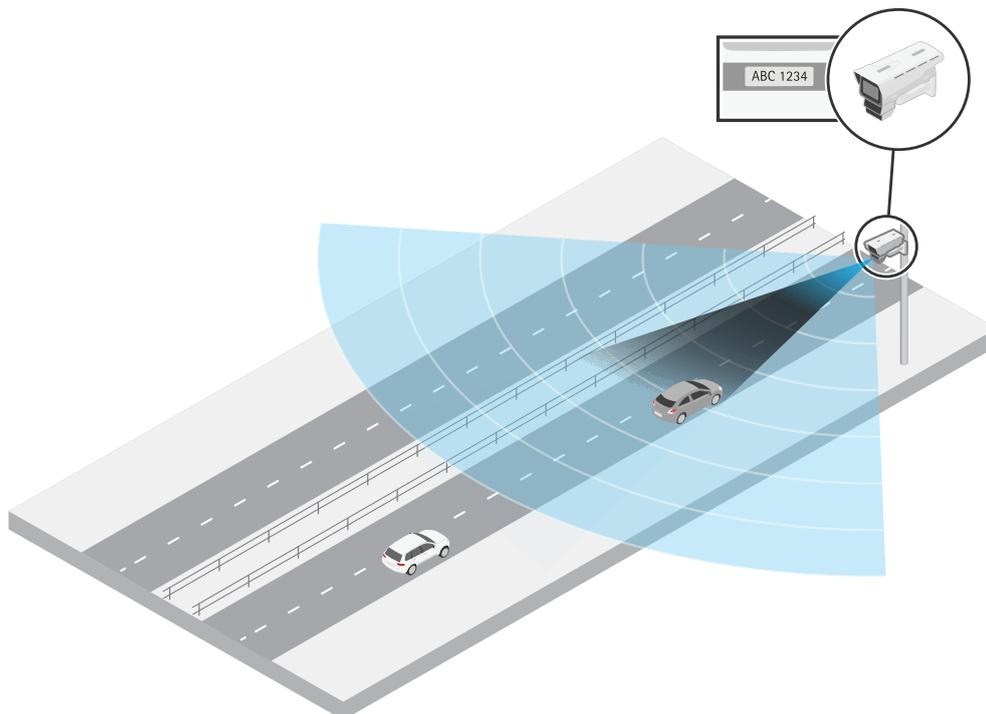
*A AXIS Q1686-DLE é montada em um poste na beira de uma rodovia e mede a velocidade e captura as placas dos veículos que se aproximam.*
