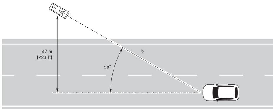
Para câmeras montadas na lateral, a distância lateral máxima recomendada para a pista *mais distante* na estrada é de 7 m (23 pés), conforme mostrado na ilustração. A ilustração também mostra o pan angle (ângulo de pan) (a) e a capture distance (distância de captura) (b).
