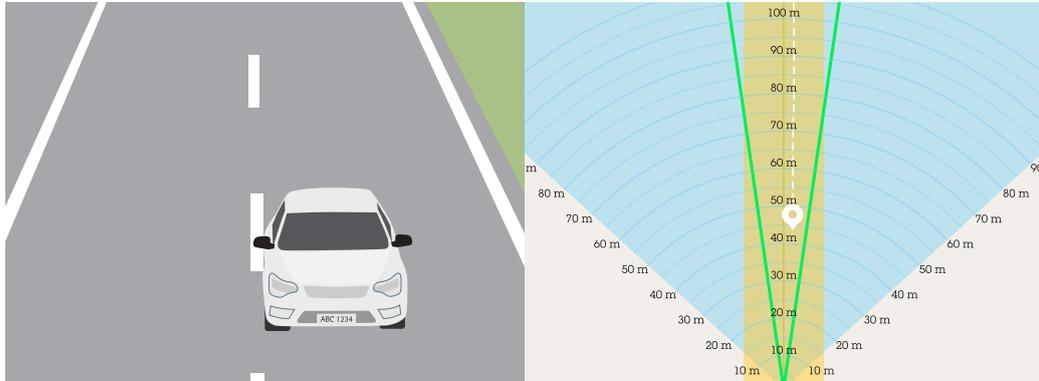
A exibição da câmera é ilustrada no lado esquerdo, e a exibição do radar com duas faixas adicionais em amarelo à direita. O carro que trafega é mostrado como uma pista branca na exibição do radar, seguida por uma trilha.
